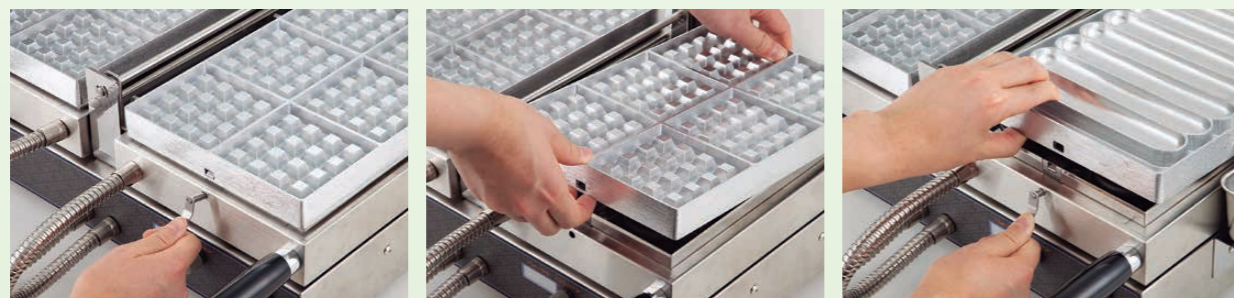
ラッチオープナーを使用してロックを解除。簡単にプレートの取り外しができる。別のプレートの取り付けも簡単。
