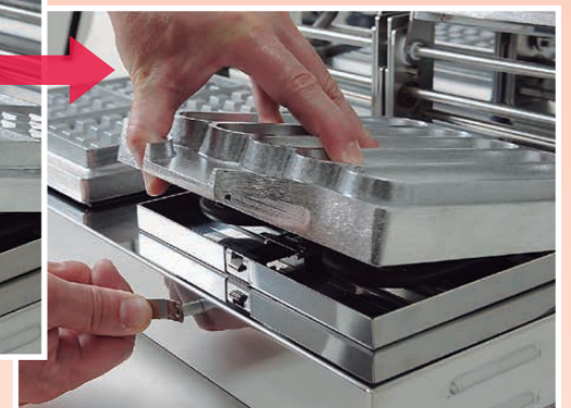
別のプレートを差し込み、ラッチオープナーでロックするだけで交換完了。
